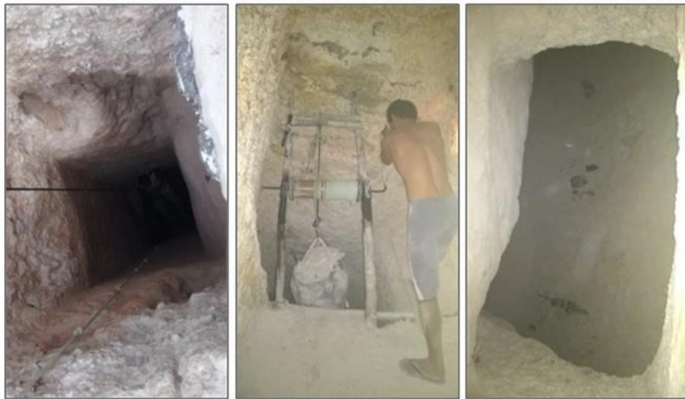
Figura 8- Lavra subterrânea (Banqueta) de caulim em Junco do Seridó
