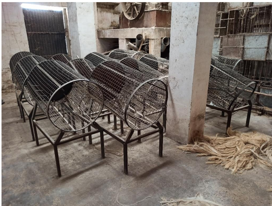
Figura 56. Vista de peneiras rotativas para tratamento de resíduos de desfibramento do sisal.
