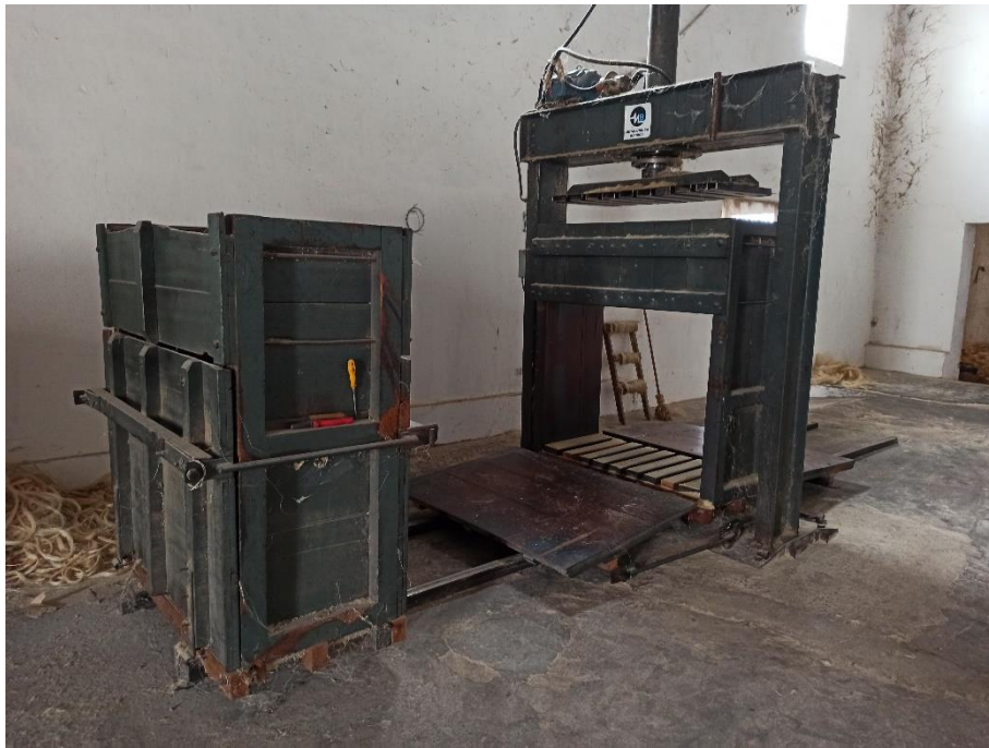
Figura 26. Vista da prensa para fardos de sisal na CAMPOL, Pocinhos, PB.
