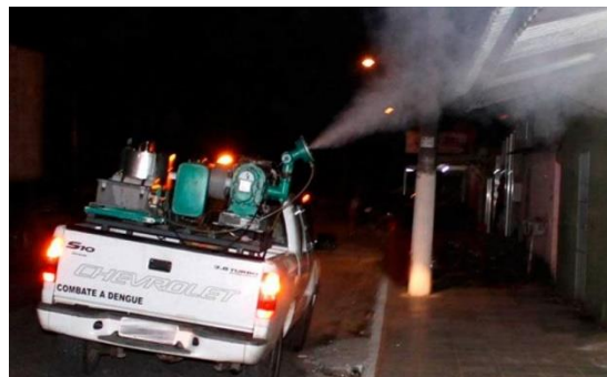
Figura 6: Equipamento nebulizador acoplado a veículos
