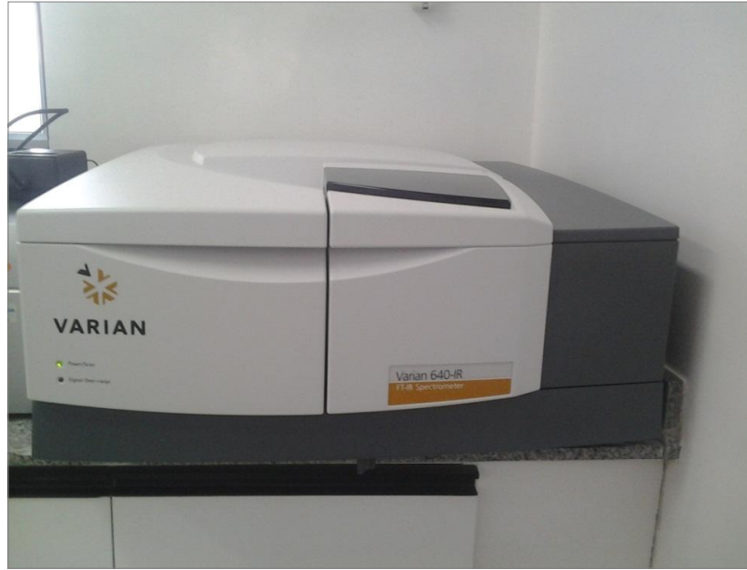
Figura 6 – Espectrômetro por infravermelho médio utilizado para predição das misturas de óleos vegetais analisadas. Campina Grande, 2012.
