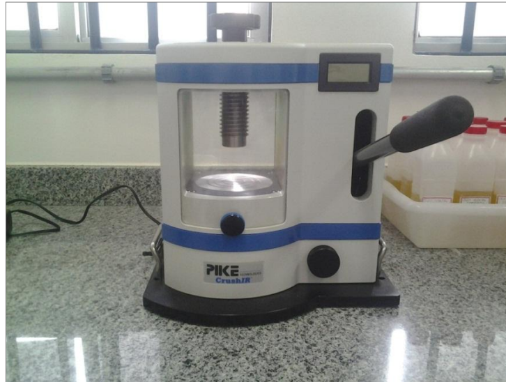
Figura 7 – Prensa hidráulica utilizada para confecção das pastilhas contendo os óleos das misturas a serem analisadas no FT-IR. Campina Grande, 2012.
