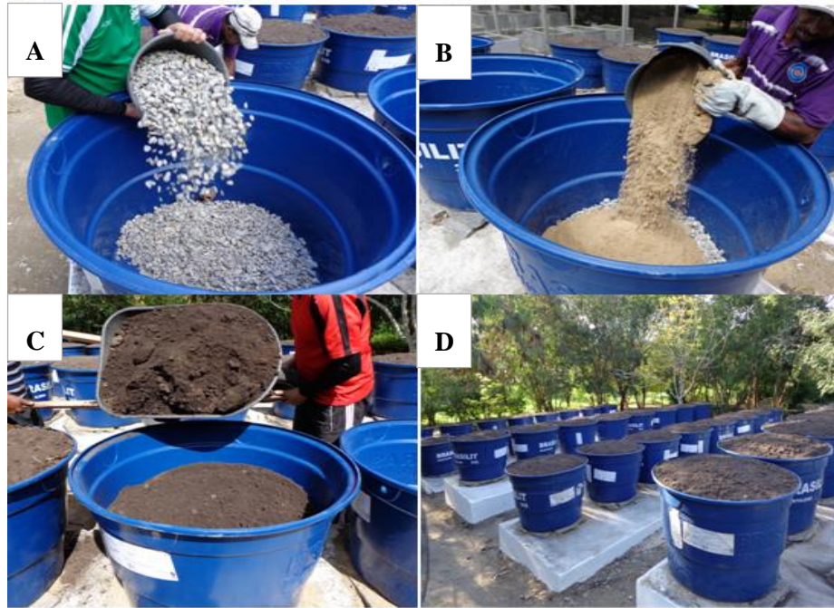
Figura 3. Sequencia de preenchimento dos lisímetros, primeiro a camada de brita miuda (A), seguida de uma camada de areia (B) e complemento com solo franco arenoso peneirado (C e D). Viveiro de mudas UEPB, Campina Grande. Foto Thiago Anderson
