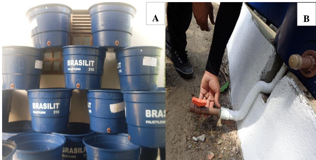
Figura 2. A - caixas utilizadas como lisímetros de drenagem; B - sistema de drenagem com registro para facilitar o escoamento da água. Viveiro de mudas UEPB, Campina Grande. Foto Thiago Anderson
