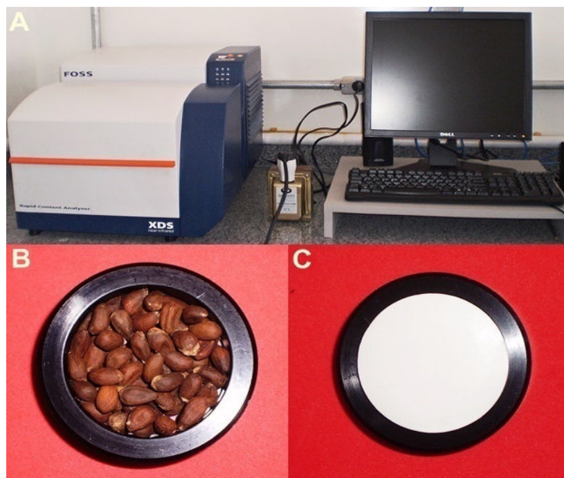
Figura 3: Análise de componentes principais no NIR: (A) espectrômetro XDS Analyser; (B) célula com sementes de algodão; (C) célula preparada para análise no NIR. Foto: Taiza da Cunha. Soares. Campina Grande, 2013.
