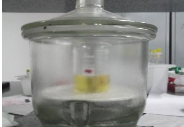
Fig 8- Dessecação do biodiesel de algodão.
