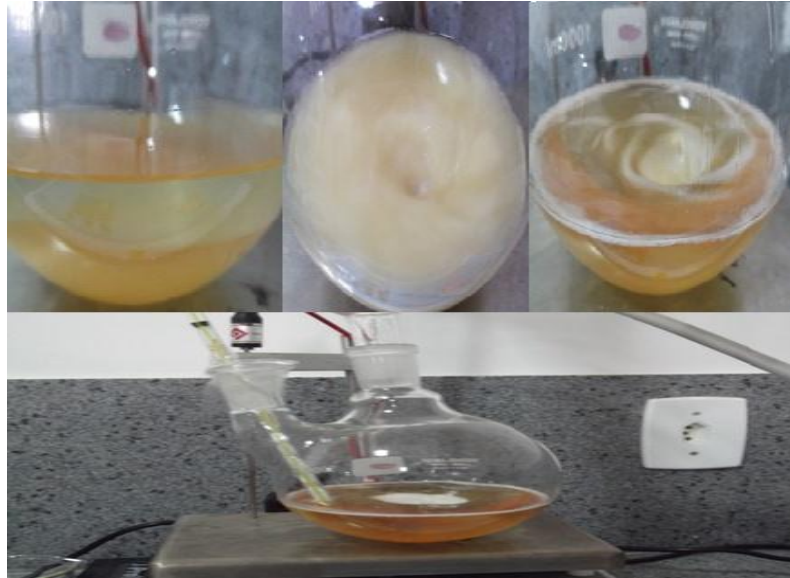
Fig. 4- Processo de transesterificação do biodiesel de algodão.
