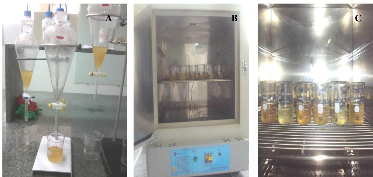
Figura 10. Tratamento térmico do biodiesel de graviola. A: Transferência de biodiesel (funil de decantação – béquer). B: Secagem do biodiesel de graviola em estufa de circulação de ar. C: Visualização de água presente no biodiesel.
