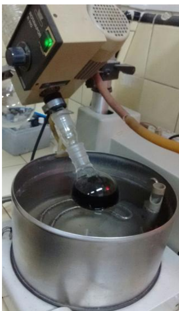
Figura. 11- Buchi rotavapor r-100, para evaporar o hexano.
