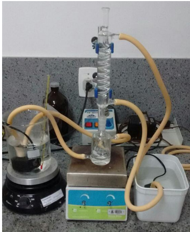
Figura 12: Equipamento de reação, com os sistemas de fluxos térmicos e rotação.
