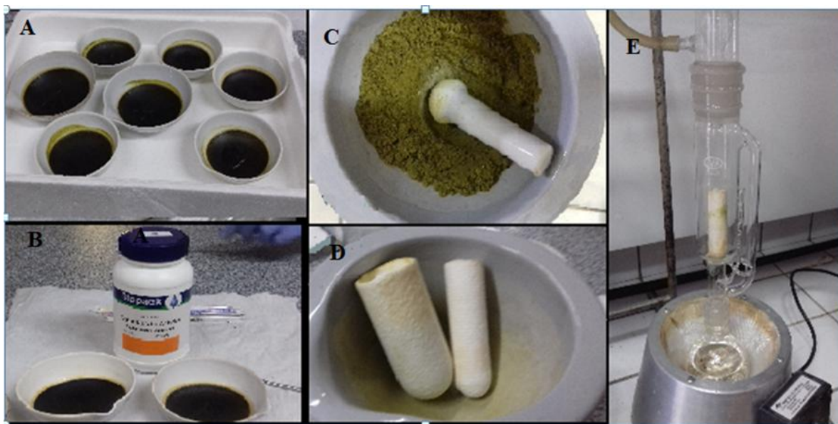
Figura 9: A) biomassa seca a 70 °C; B) biomassa seca com sulfato de sódio; C) biomassa em argamassa; D) cartuchos de papel com biomassa no interior; E) Soxhlet no início da operação.
