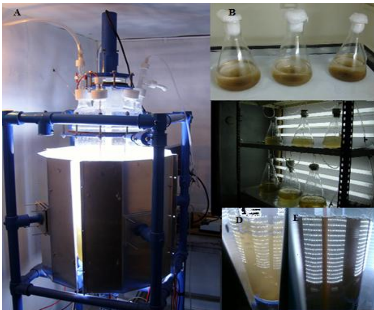
Figura 8: A) fotobiorreator; B) culturas em uma fase de ampliação; C) culturas com aeração enriquecida com CO 2 ; D) cultura em STR no dia 2; E) cultura em STR no dia 6.
