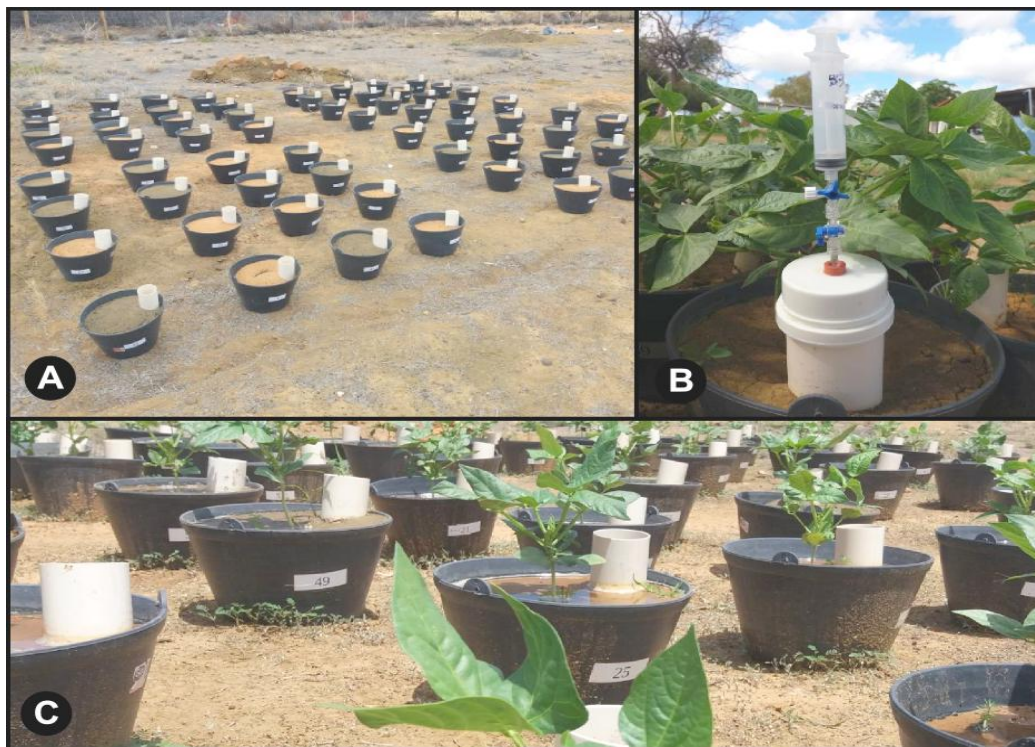
Figura 4: (A) Distribuição dos tratamentos em campo, (C) Bases das câmaras fixadas ao solo, (B) Câmara com todos os componentes e pronta para coleta dos GEE.
