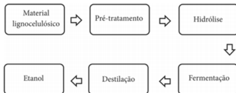
Figura 5. Rota tecnológica da biomassa lignocelulósica, para obtenção de etanol (Fonte: SANTOS, F. et al., 2012) adaptada.
