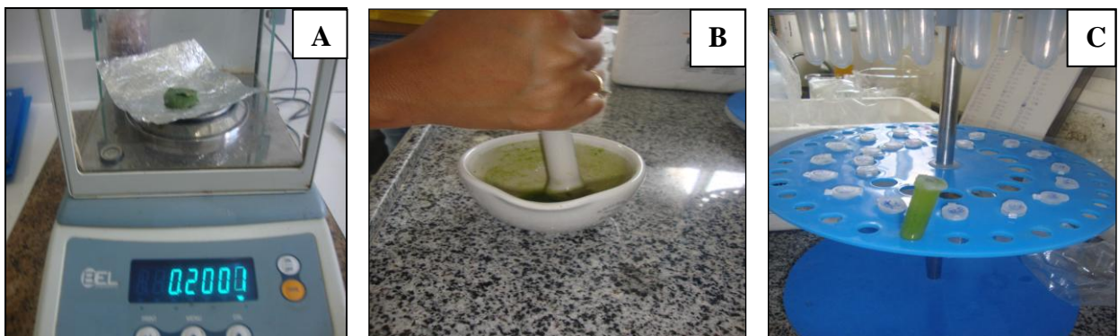
Figura 5. Balança de precisão (Mod. FA – 2104N, Bioprecisa®) (A). Maceração de matéria fresca em nitrogênio líquido (B). Microtubo contendo o extrato enzimático macerado, para posterior armazenamento em refrigerador a -80 o C (C). Fotos: Angélica Vilar, Embrapa Algodão, Campina Grande – PB, 2011.
